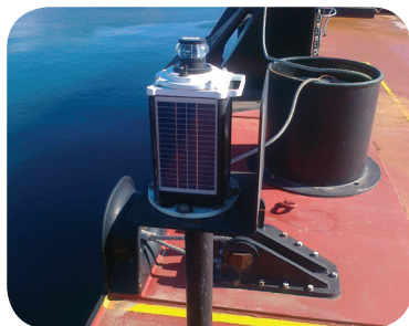
BargeSafe™ Solar instalada en Eslovenia
